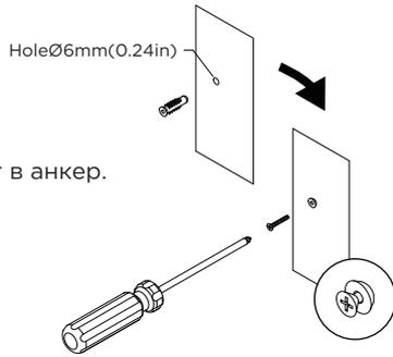
Шаг 2. Вставьте и затяните винт в анкер. Оставьте достаточную часть винта открытой для крепления датчика.
